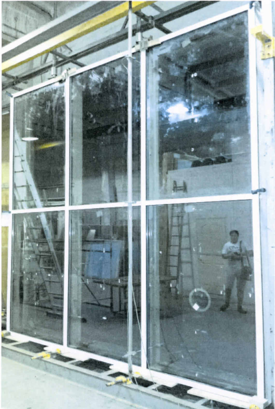
Рис.4. Внешний вид образца, на стенде для испытаний на воздухо- и водонепроницаемость и сопротивление ветровой нагрузке ВВВ-2008.
