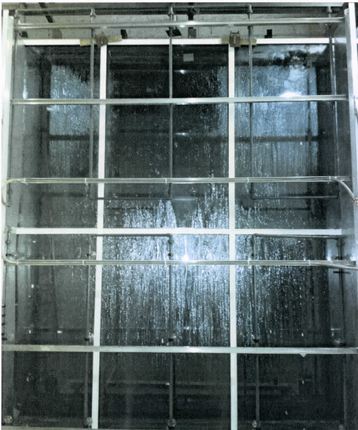
Рис.5. Внешний вид образца, при проведении испытаний по водопроницаемости .
